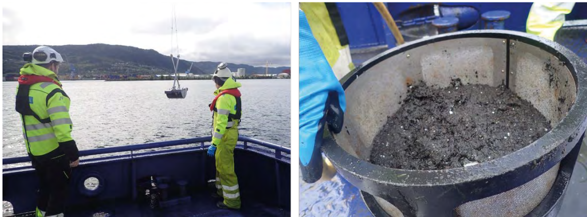
Figur 2.3 van Veen grabb (0,1 m 2 ) som brukt ved prøvetaking av sediment (til venstre). Sedimentet ble vasket igjennom en sikt med 1 mm lysåpning før analyse av bløtbunnsfauna (til høyre). Foto: Kristin Møller Gabrielsen, Rambøll.
