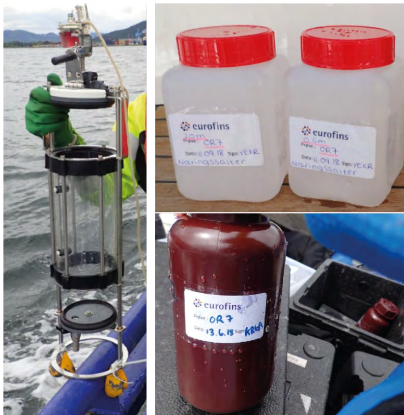
Figur 2.2 Ruttner vannprøvetaker (til venstre) og prøveflasker til oppbevaring av næringssalter (øverst til høyre) og klorofyll-a (nederst til høyre). Det ble benyttet mørke flasker for å skjerme prøvene fra lys og dermed fotodegradering. Foto: Kristin Møller Gabrielsen, Rambøll.
