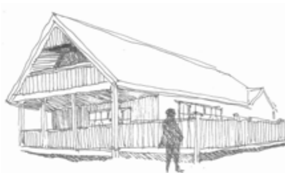
Det er uheldig at boligen er kringsatt av verandaen og at balkongen tar dagslys fra stua.
